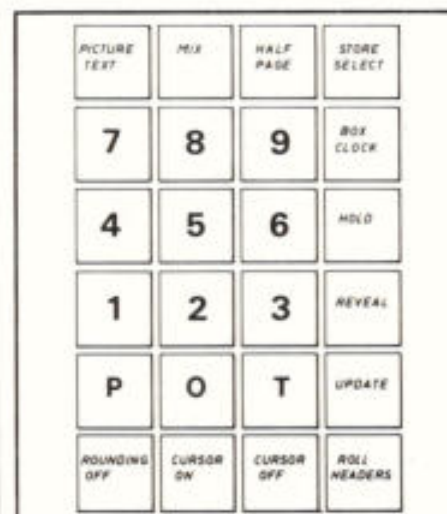
Fig. 4. Een mogelijke toetsenborduitvoering met 24 toetsen voor infrarode afstandbediening van teletekst.
